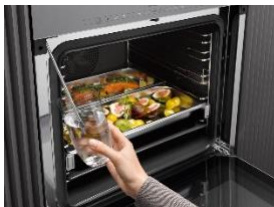
Foto 2: Zum Dampfgaren saugt ein Edelstahl-Rohr am Türrahmen vor dem Garvorgang das nötige Wasser aus einem geeigneten Gefäss. Mit dem so befüllten Tank lässt sich bis zu einer Stunde zwischen 70 °C und 100 °C mit Dampf garen. (Foto: Miele)
